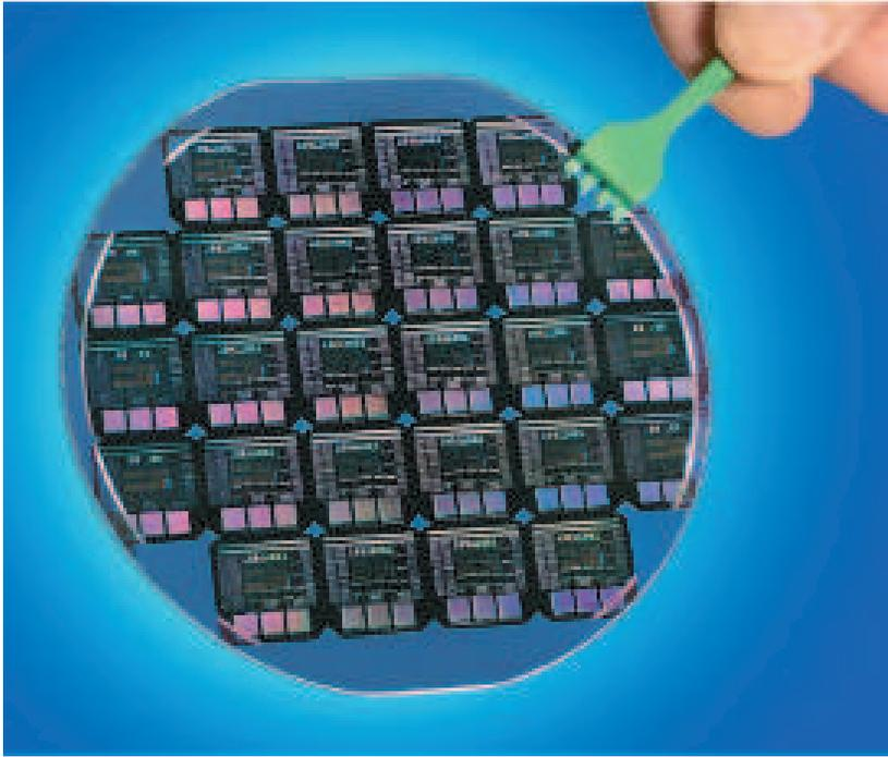
CCD wafer –200 x 200 pixel
